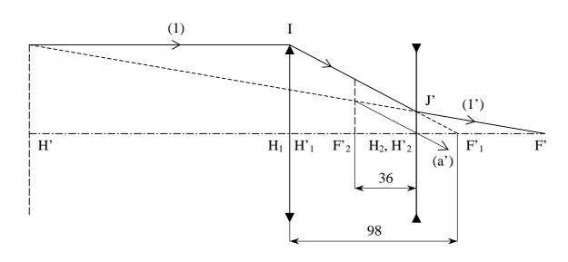
Un rayon incident parallèle à l'axe optique(1) et le rayon émergent correspondant (1') se coupent sur le plan principal image. La droite IJ', qui joint les intersections respectives de ces rayons avec le plan de la première lentille et le plan de la seconde, coupe l'axe optique en  $F'_1$ .
