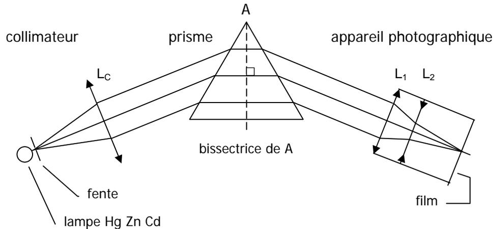
Le collimateur est constitué d'une fente rectangulaire, de largeur négligeable, orientée parallèlement à l'arête A du prisme, et placée dans le plan focal objet d'un objectif  $L_c$ .
